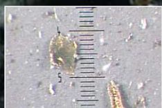
Загрязнение механическими примесями
